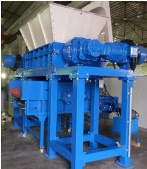
**Abbildung: Vierwellen Shredder für Biomasse und Plastischen Müll.**
