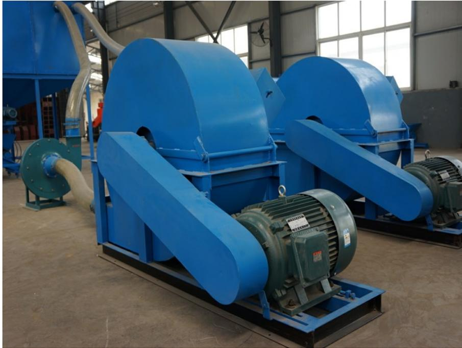
**Abbildung: Hammermühlen mit Gebläse**
