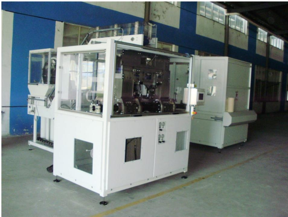
**Abbildung: Brikett Presse für Stroh mit Reinigungssystem und Aufbereitung**
