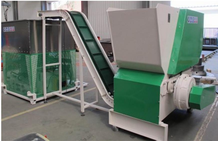
**Abbildung: Brikett Presse mit Shredder, Magnetabscheider und Transportband**
