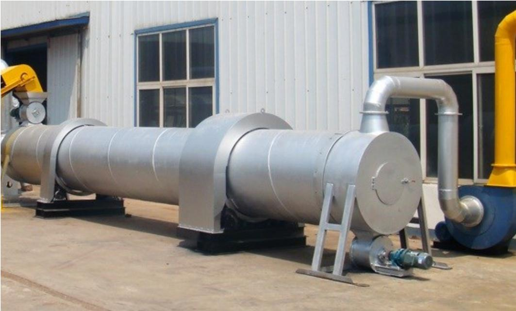
**Abbildung: Trommeltrockner mit Beschickung und Austragungssystem. Leistungsbereiche ab 1.000 KG/h bis 4.000 KG/h. Sondertrockner als Modul für besondere Anforderungen ab 3.000 KG/h bis 6.000 KG/h.**
