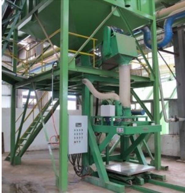
**Abbildung: Verpackungsanlage für Pellet in BigPack**
