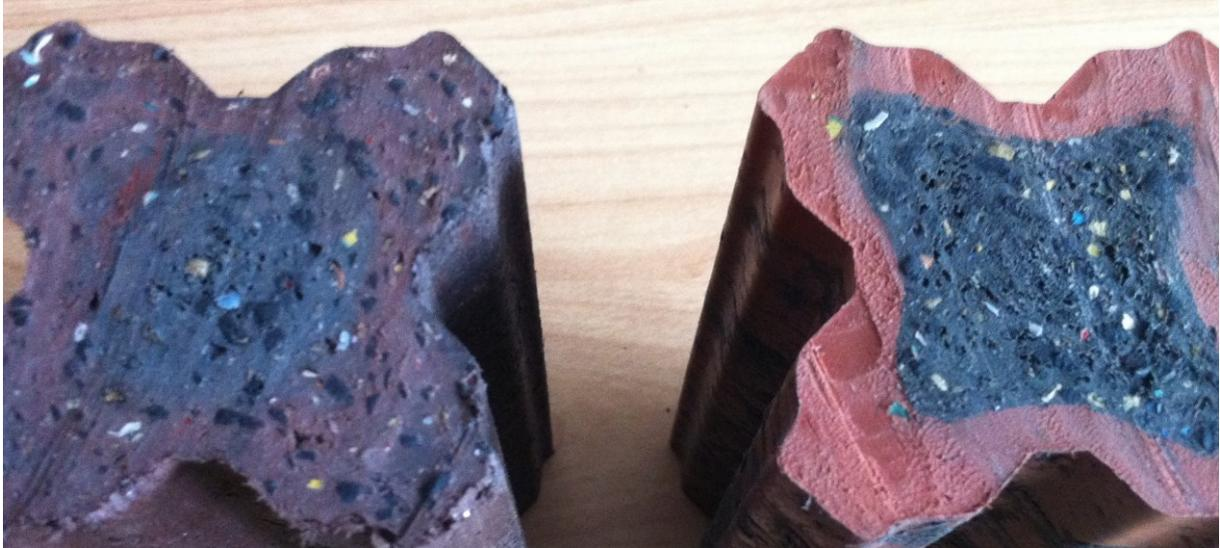
**Abbildung links: Plastischer Hausmüll mit Gummi und Ascheanteil verarbeitet.**
