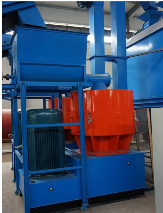
**Abbildung: Pellet Pressen mit Beschickung automatisch**
