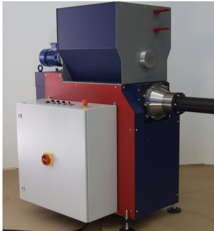
**Abbildung: Extruder Presse Model Deon**
